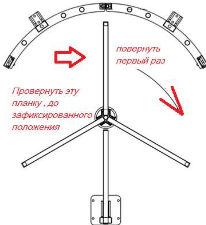
Рисунок 7 – Второй проворот ротора до следующего преграждающего положения
