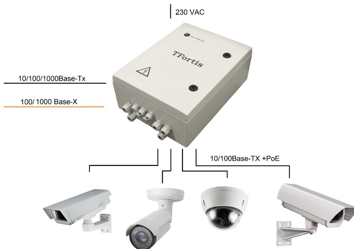
Рисунок 1 - Схема подключения PSW-1G4F-Box
