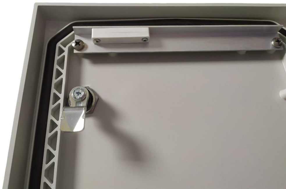
Рисунок 3.6.1 - Датчик вскрытия на крышке коммутатора
