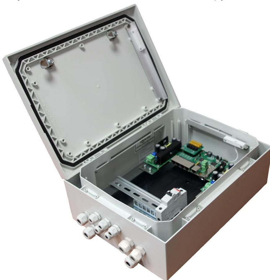
Рисунок 3.1.2 - PSW-1G4F-Box - вид внутри
